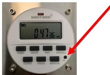
Le générateur d'ozone est équipé d'une minuterie programmable qui permet de contrôler le temps de fonctionnement de l'appareil.
