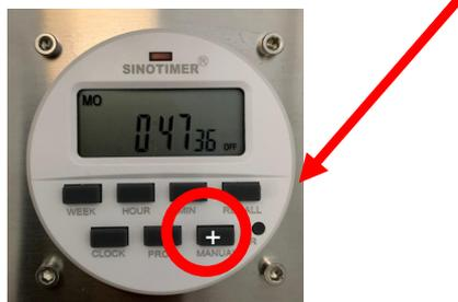
In der "ON"-Position ist das Gerät kontinuierlich eingeschaltet und bleibt auf unbestimmte Zeit eingeschaltet. In dieser Position schaltet es sich nie aus.
