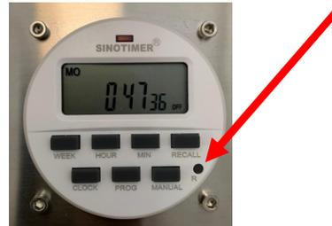
Der Ozongenerator hat eine programmierbare Zeitschaltuhr installiert, mit der die Betriebszeit der Anlage gesteuert werden kann.
